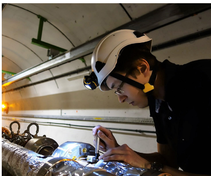
Michał Krupa instalujący prototypowy system do pomiarów natężenia wiązki w Wielkim Zderzaczu Hadronów
