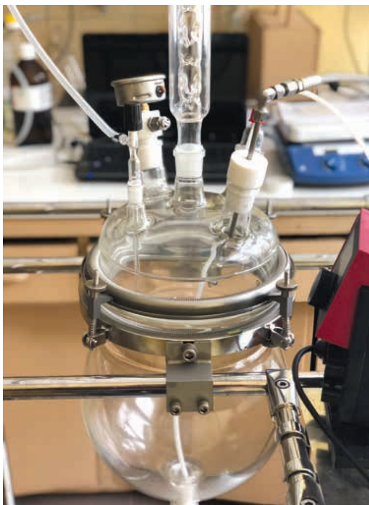
Reaktor służący do wprowadzenia ozonu do próbki oleju
