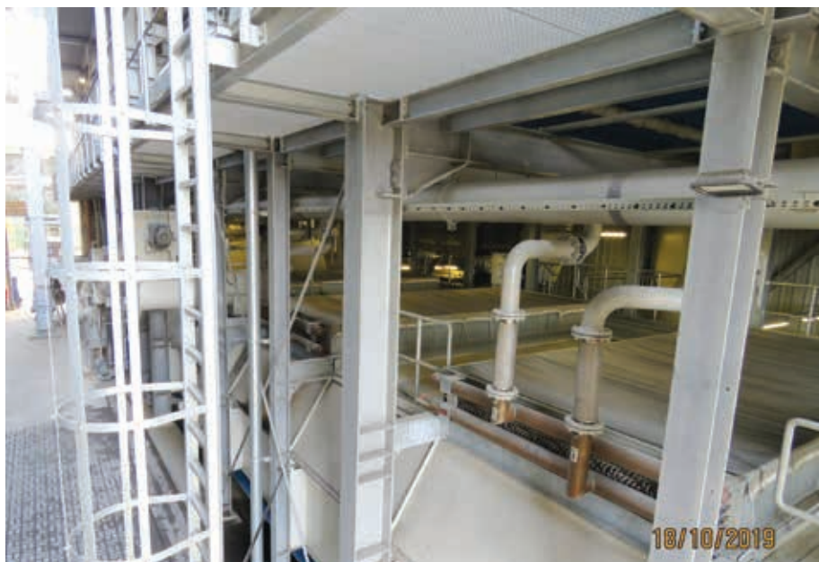
Suszarnia wysłodków wykorzystuje ciepło odpadowe z cukrowni
