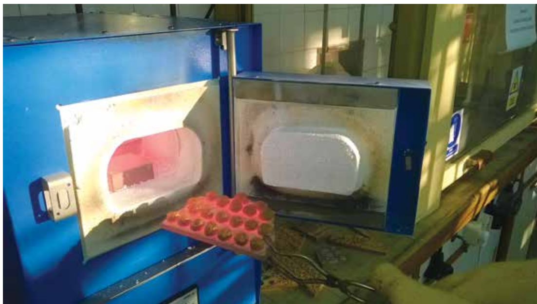
Próbka poddawana testom ceramizacji w piecu muflowym
